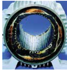
10 Falta de fase (conectado en estrella)
